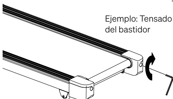
Ejemplo: Tensado del tornillo derecho
