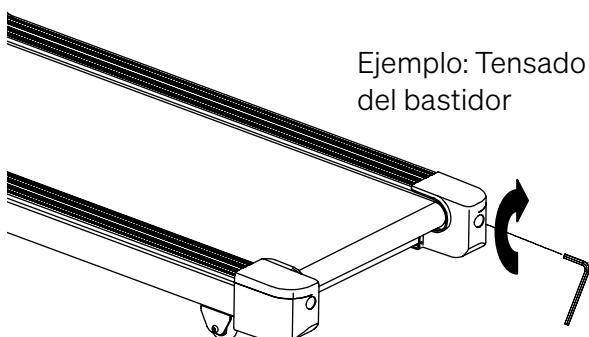
Ejemplo: Tensado del tornillo derecho
