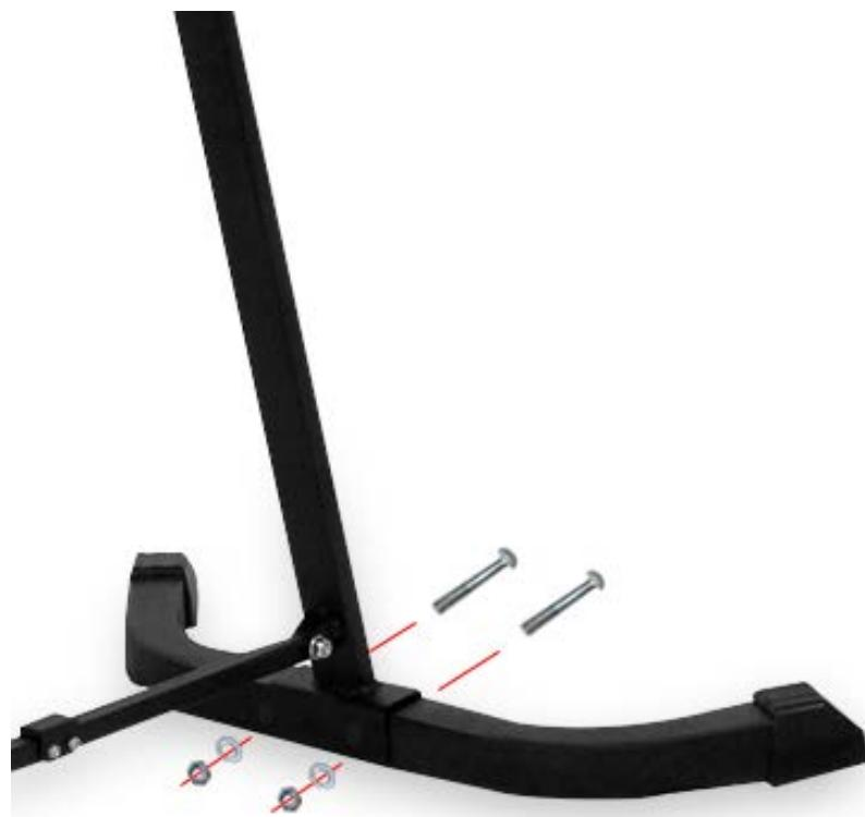
Ubique el tubo posterior base (30) debajo de la marco de soporte (2). Asegúrese de que las puntas de la base apunten hacia atrás. Conecte ambas piezas con 2 tornillos, arandelas planas y tuercas.
