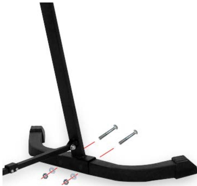
Placez le tube du pied arrière (30) en dessous de la cadre de support (2). Assurez-vous que les pointes du pied tournent vers l'arrière. Fixez les deux pièces avec la vis 2x, la rondelle plate et l'écrou.
