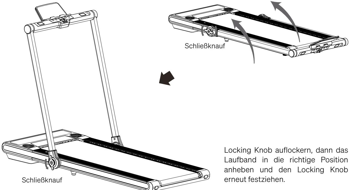
Locking Knob auflockern, dann das Laufband in die richtige Position anheben und den Locking Knob erneut festziehen.
