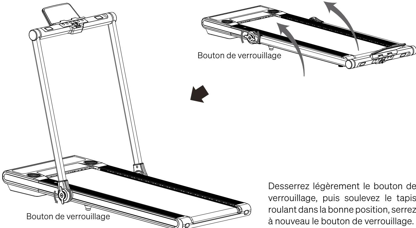
Desserrez légèrement le bouton de verrouillage, puis soulevez le tapis roulant dans la bonne position, serrez à nouveau le bouton de verrouillage.
