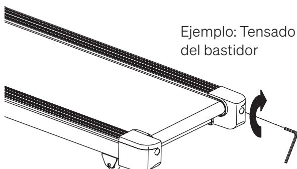
Ejemplo: Tensado del tornillo derecho
