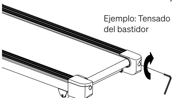
Ejemplo: Tensado del tornillo derecho
