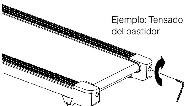
Ejemplo: Tensado del tornillo derecho
