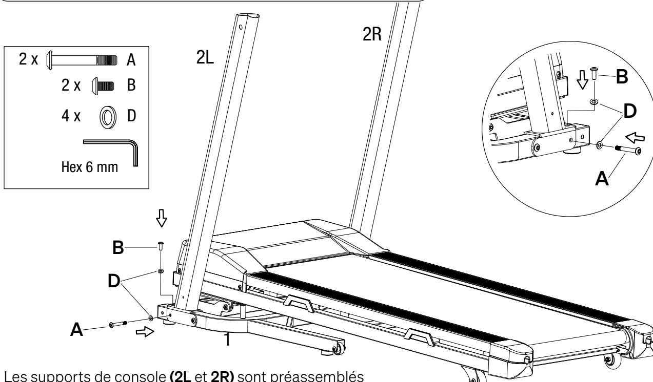
Les supports de console (**2L** et **2R**) sont préassemblés sur le cadre de base (**1**).
