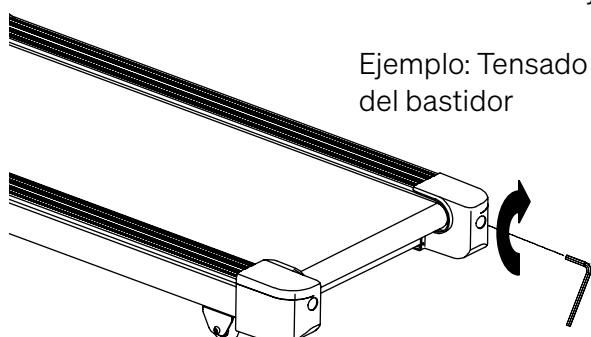
Ejemplo: Tensado del tornillo derecho del bastidor
